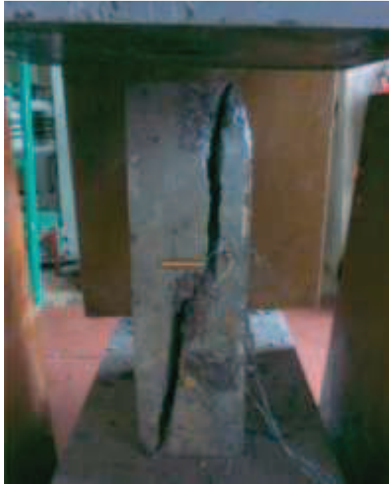
Рис.1 – Характер руйнування дослідної призми
