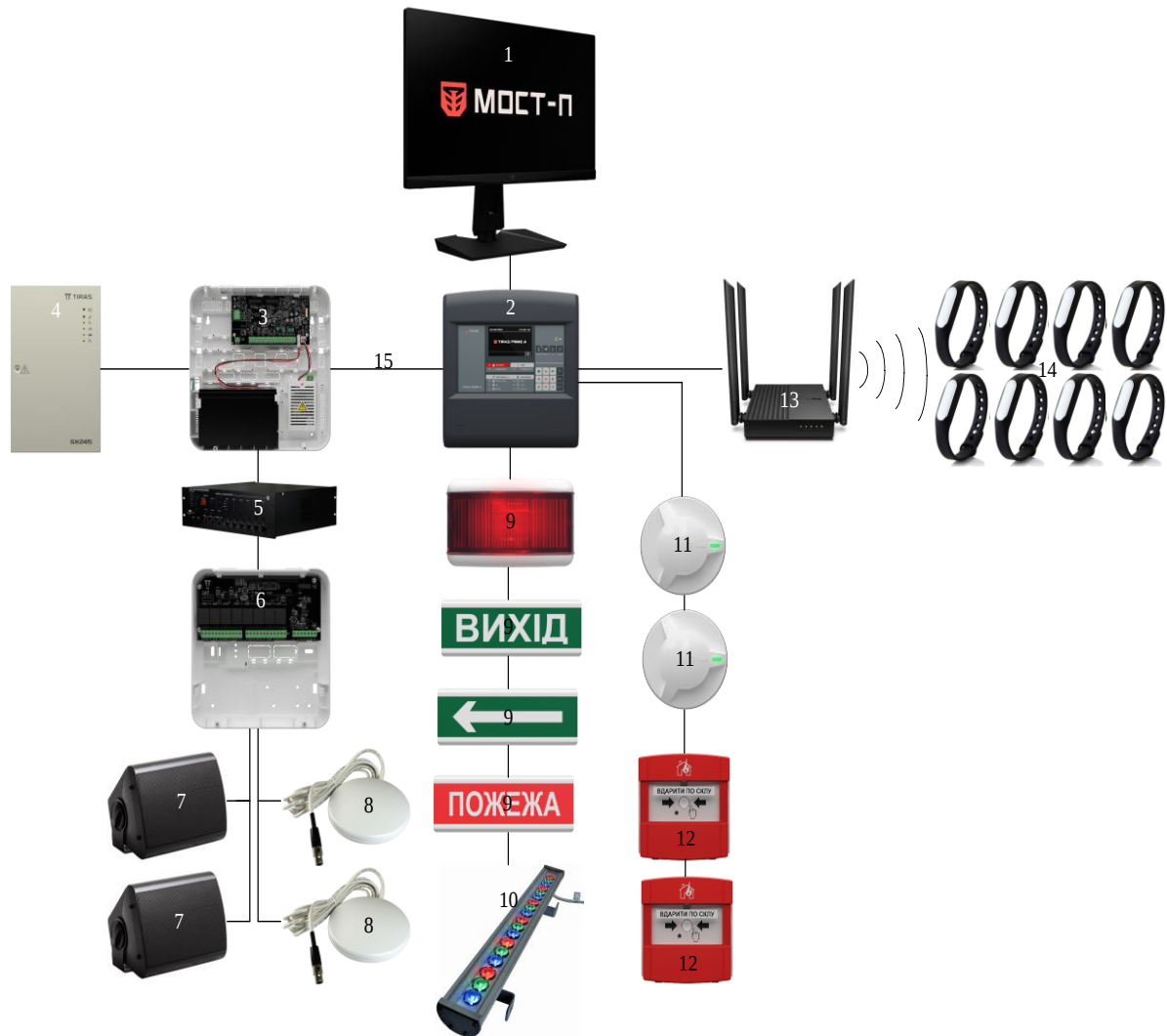
Рис. 3. Структура системи оповіщення та управління евакуацією дітей з порушенням слуху.
