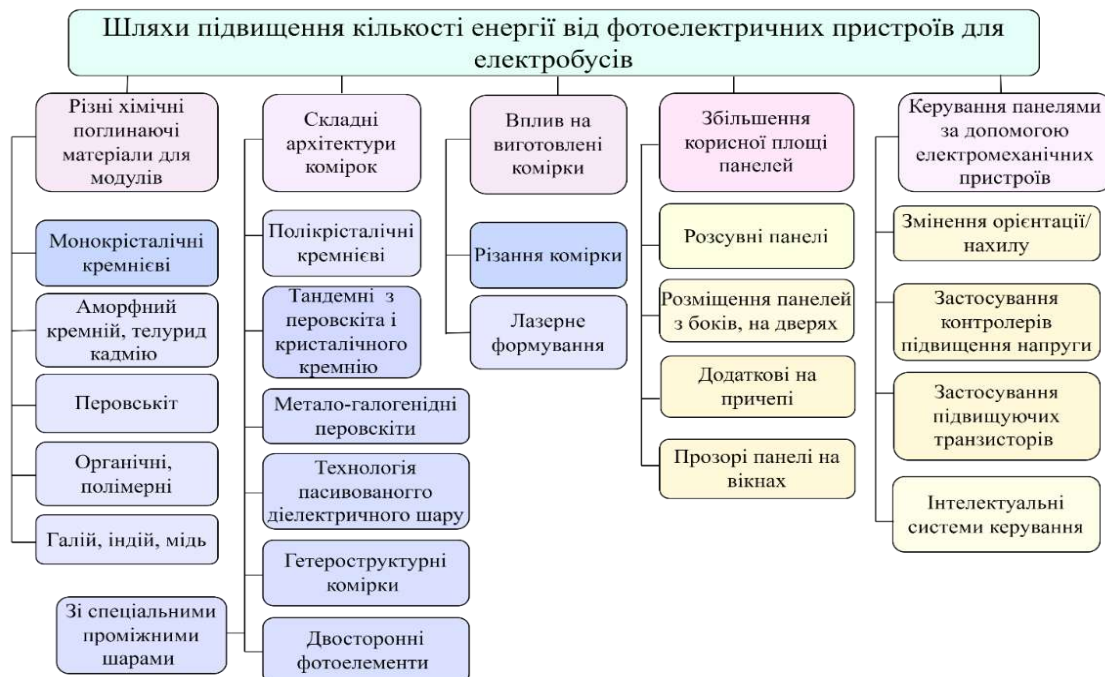
Рис. 1 Класифікація шляхів підвищення кількості енергії від фотоелектричних модулів у разі використання на електробусах
