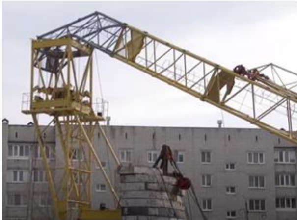
Рис. 4. Втрата стійкості та обвалення поворотної вежі крана КБ-403, у бік протизаги
