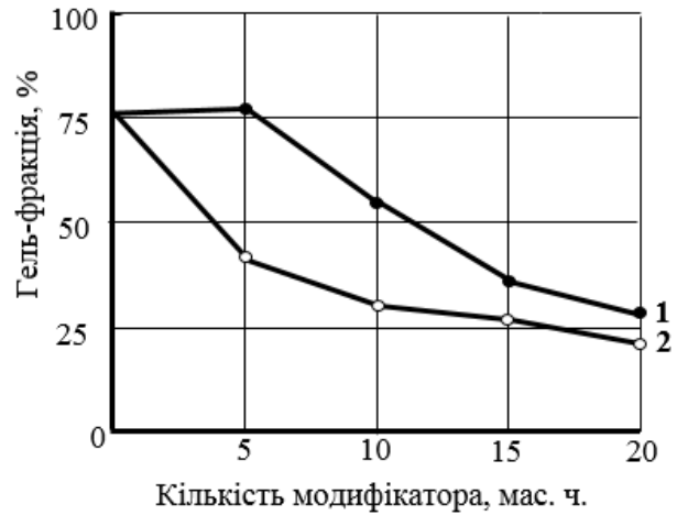
Рис. 3. Залежність виходу гель-фракції для епоксидного сполучника від кількості модифікатора: 1 – олігомер ЕХД; 2 – смола УП-631
