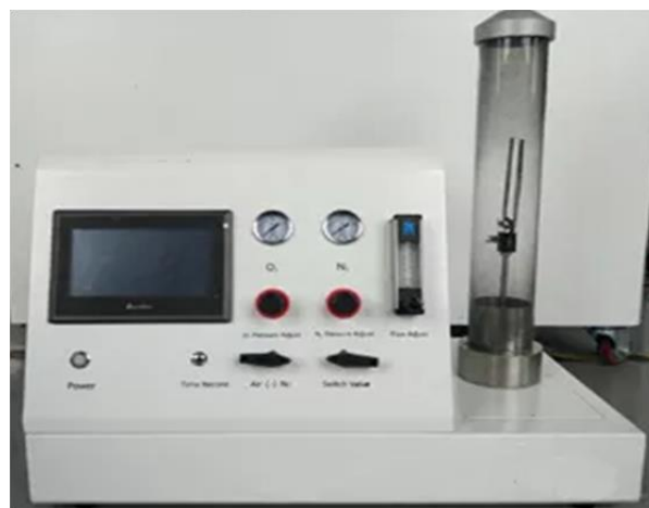
Рис. 1. Прилад для визначення кисневого індексу склопластикових зразків
