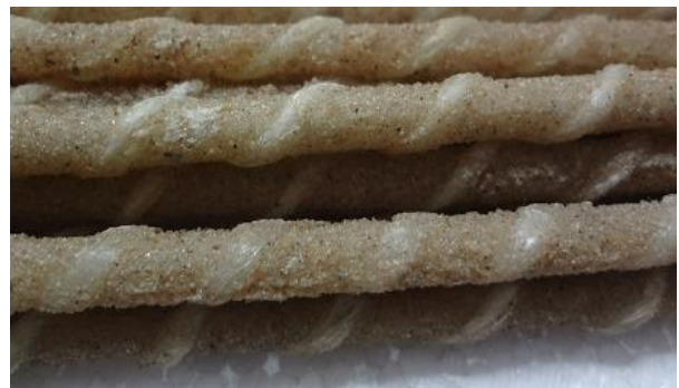
Рис. 2. Композитна склопластикові арматура з навивкою та зовнішнім піщаним покриттям
