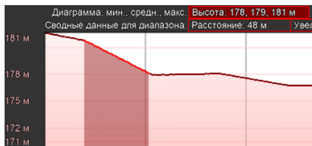
Рис. 2. Отримання перевищень між точками злому поздовжнього профілю
