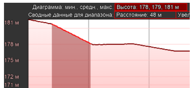
Рис. 9. Отримання перевищень між точками злому поздовжнього профілю
