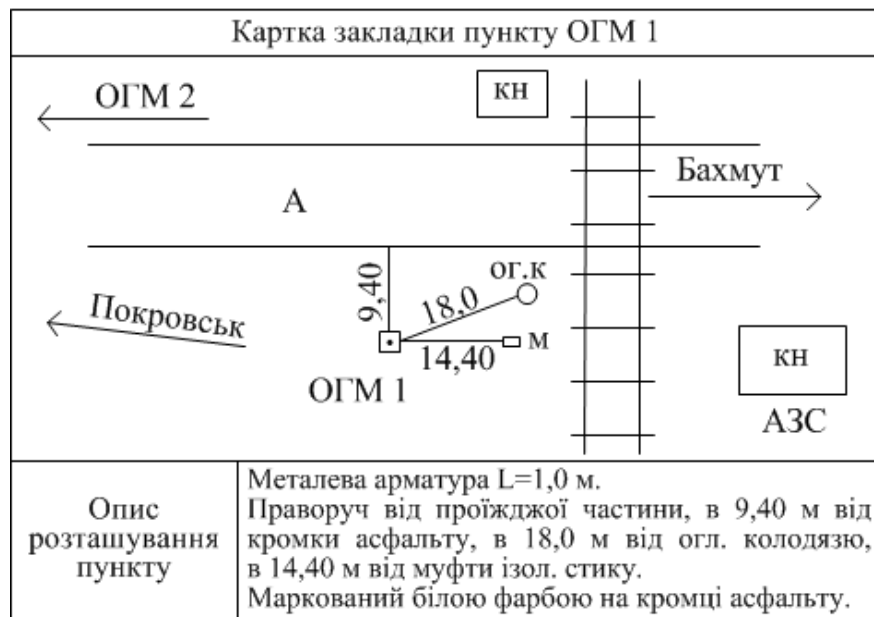
Рис. 1. Приклад картки обліку пункту опорної геодезичної мережі
