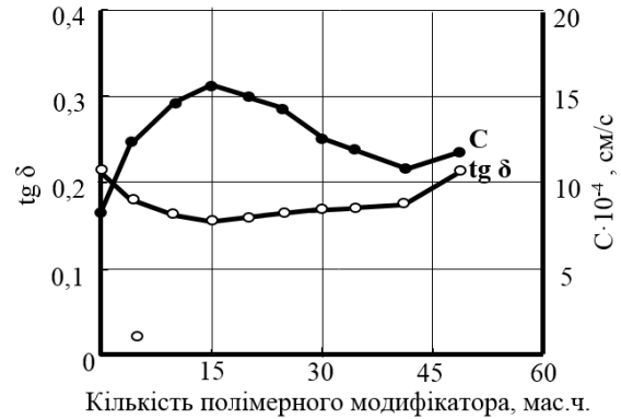
Рис. 2. Залежність швидкості звуку та тангенса угла механічних втрат від кількості полімерного модифікатора ПСМ
