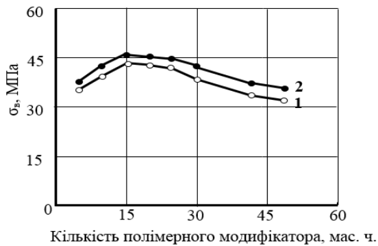
Рис. 1. Залежність руйнуючої напружки при статичному вигині від кількості полімерного модифікатора: ПС - 1, ПСМ - 2
