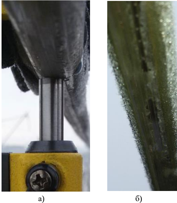
Рис. 2.2 – Виконання замірів в умовах покриття контактного проводу ожеледдю.
