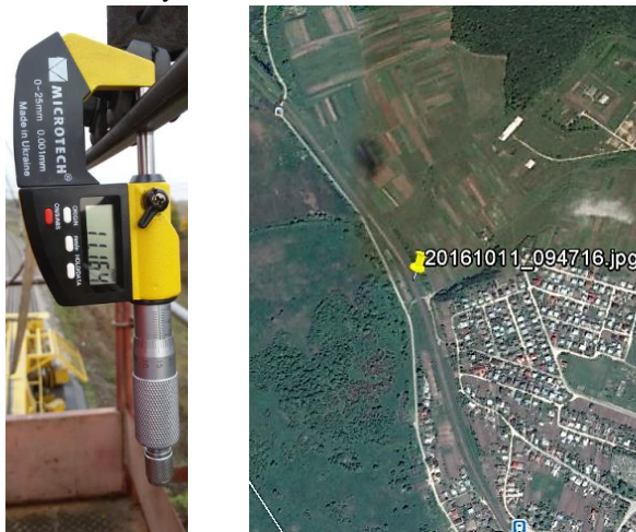
Рис. 1.1 – Фотографія виміру висоти контактної проводу з фіксацією координат по GPS.
