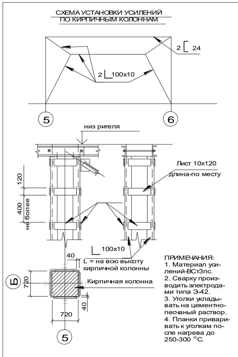
Рис. 7. Схема установки усиления по кирпичным колоннам
