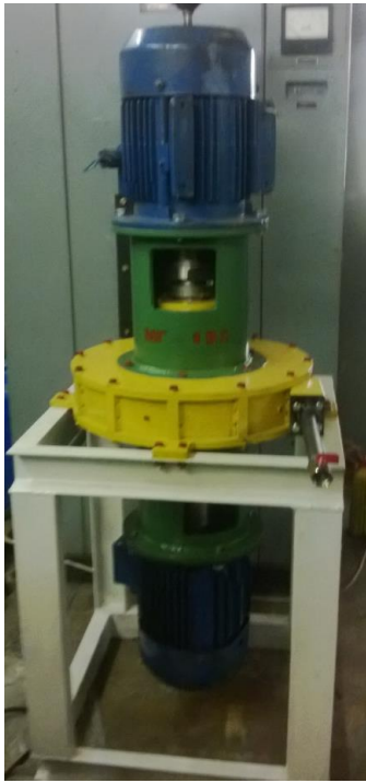
Рис. 2. Устройство для гидрокавитационной активации топливных эмульсий и суспензий
