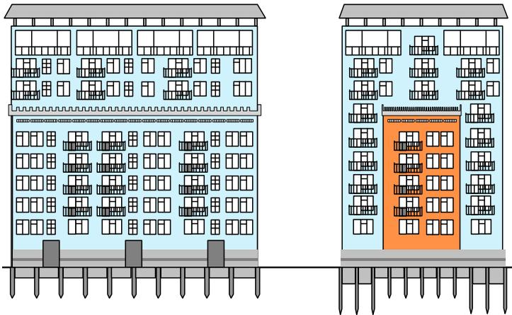
Схема реконструкции пятиэтажки
